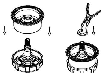
4. Поместите поршень в фильтрующий элемент, смажьте основание фильтрующего элемента глицерином, и введите фильтрующий элемент, осторожно вдавливая его в основание фильтра
