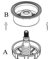
3. Проверьте уплотнительное кольцо в части В. Также проверьте пружину в части А
