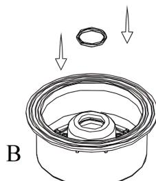
3. Вставьте часть В в часть А, и установите стопорное кольцо согласно схеме. Для удобства используйте обратные плоскогубцы
